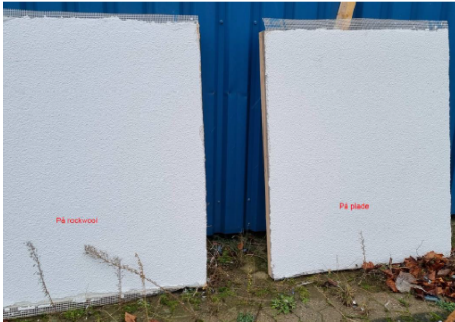
Foto af de fremviste løsninger. Til venstre puds direkte på isolering. Til højre den godkendte løsning.
